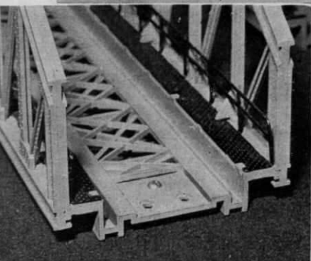
Abb. 184 u. 185. Die neuen Brücken in Modellausführung zur Aufnahme von K- und M-Gleisen (siehe stirnseitige Profilierung in Abb. 185).
