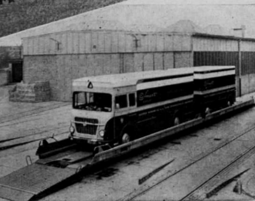
Abb. 158 u. 159 (oben). Zwei der Niederflurwagen und ein Wagenende (mit einer der verschiebbaren und einsteckbaren Bremschuh-Einheiten) nah besehen.
