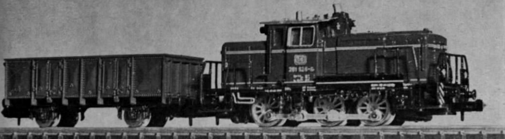
Abb. 277. Zum guten Glück nicht noch 'ne V 100, sondern Minitrix hat sich erfreulicherweise der V 60 angenommen, die ein sehr gutes N-Modell zu werden verspricht. Nicht minder fein detailliert: das Modell des Eo 058.
