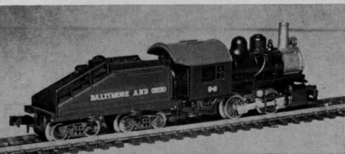
Abb. 231. Im Rivarossi H0-Katalog fälschlicherweise als „Mallet“-Lok bezeichnet. In Wirklichkeit handelt es sich, wie die Zylinderanordnung eindeutig verrät, um eine früher nur in Sachsen heimische Meyer-Lok I TV, die später die Baureihennummer 98 o erhielt. Eine dieser Loks (die 98 001) steht übrigens in Dresden und soll später einmal im Dresdner Verkehrsmuseum einen gebührenden Platz erhalten.
