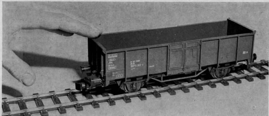
Abb. 236 u. 237. Der neue UIC-Güterwagen der DB in O-Größe, mit einer LÜP von 22,5 cm. Wie ausgezeichnet detailliert er ist, verrät das nebenstehende Bild. Rahmenwerk und Bremsgestänge sind nicht am Boden angespritzt, sondern richtig plastisch ausgeführt.
