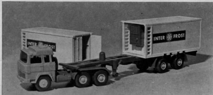
Abb. 302. Der Großcontainer-Sattelzug mit zwei (abnehmbaren) Kühl-Containern.
