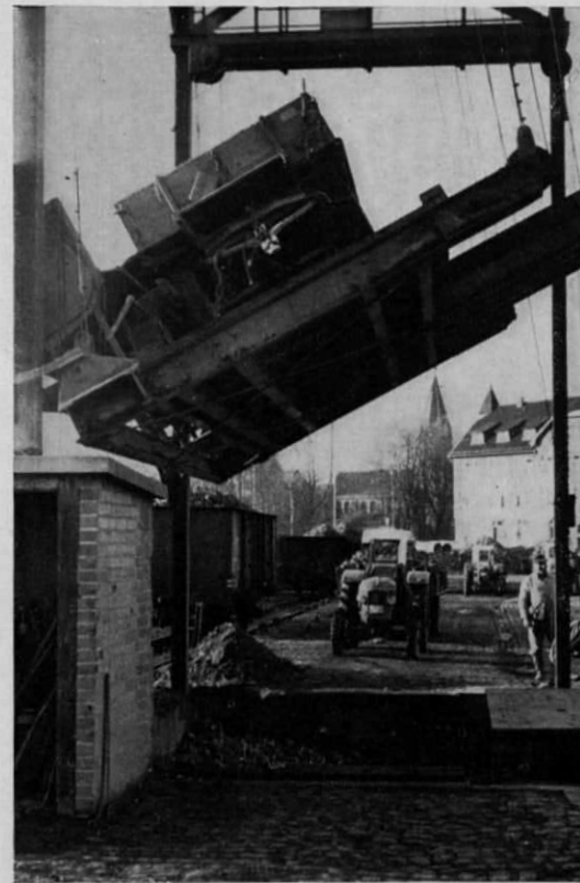
Abb. 7. Die Bühne wird hochgehoben und der Führungskasten beginnt — bedingt durch die Form der Führungsschienen — erst jetzt zu kippen.
