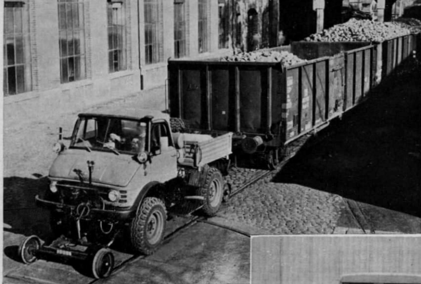
Abb. 4. Der Unimog mit Schienenführungsrollen vor einem Güterzug. Die Zugkraft dieses im Verhältnis „winzigen“ Fahrzeugs ist in der Tat enorm; sie reicht aus, 300 t Waggonlast mühelos zu rangieren.
