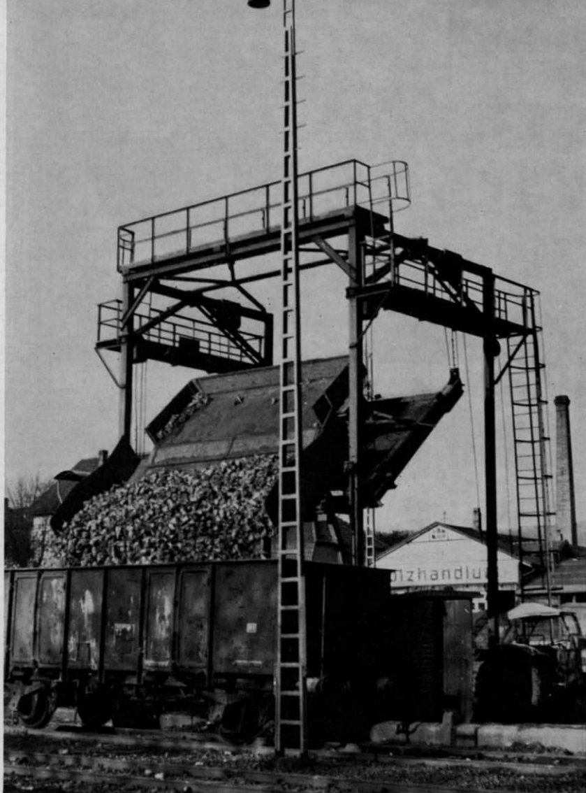
Abb. 1. Die Rübenverladeanlage (8 t-Hubkipper) auf dem Güterbahnhof von Einbeck.
