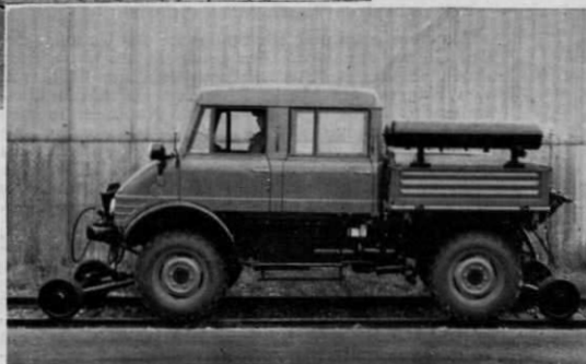
Abb. 6. Ries-Unimog vom Typ U 80 mit Doppelkabine, zusätzlichem Behälter für Hydraulik-Flüssigkeit und Zusatzballast. (Abb. 4 u. 6. Werkfotos Ries)
