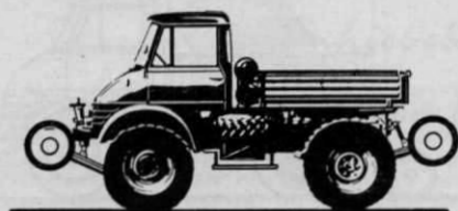
Abb. 5. Einer der Ries-Unimogs mit angehobenen Schienenführungsachsen (Prospekt-Zeichnung in 1/4 H0-Wiedergabe).
