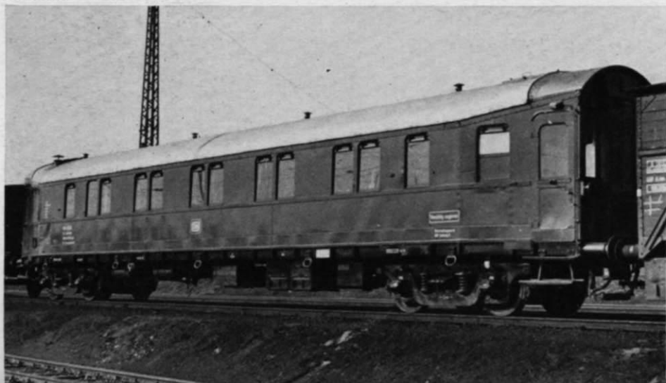
Abb. 3. Ein ehem. Schlafwagen 3. Klasse (hier die Abteilseite), nach dem Umbau zum „Wohn- und Schlafwagen für Kranmannschaften“ Mst 8018 Bw Osnabrück. Auf dem kleinen Schild vorn überm Drehgestell steht „Vorsichtig rangieren“.
