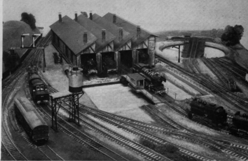
Abb. 5. Die (vom Erbauer fälschlicherweise „AW“ genannte) Ausbesserungswerkstatt (7) mit Schiebebühne (6) und daneben angeordneter Drehscheibe (8), die aus anderer Sicht bereits auf dem Titelbild von Heft 11/69 zu sehen war. Im Vordergrund die Besandungsanlage (11) und hinten neben der „AW“ (lies: Ausbesserungswerkstatt) — zur Sicherung der An- und Ausfahrt — die Signalbrücke (12).
