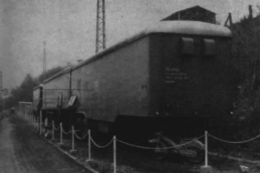
Abb. 2. Die beiden Relaiswagen sowie der Stromversorgungswagen (hinten gerade noch erkennbar).
