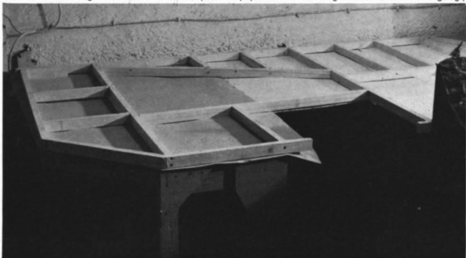
Abb. 2. Das Grundgerüst aus 2 x 4 cm-Latten. (Das Packpapier ist nur aus fotografischen Gründen untergelegt).
