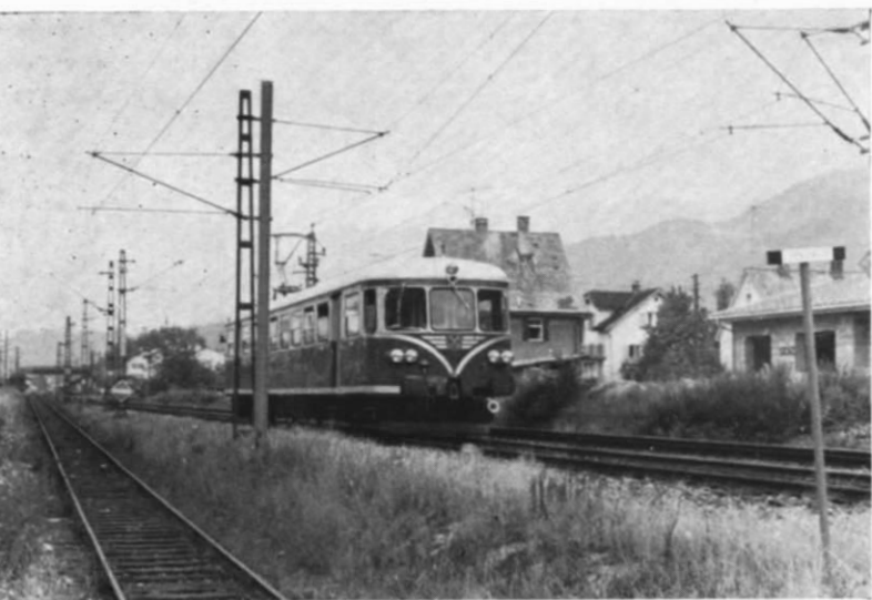
Abb. 1. Einfahrt der Montafoner Bahn in den ÖBB-Bahnhof Bludenz; Trennstelle zwischen den 750 V Gleichstrom der MBS und den 15 000 V der ÖBB mit zwischen-gelegenem geerdeten Abschnitt.
