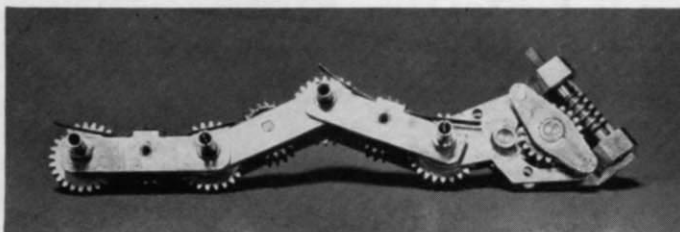
Abb. 11. Der Gelenkarm mit dem Zahnradgetriebe und Schneckenwelle; letztere wird so angelenkt, daß sie waagrecht im Kessel liegt, wo sie mittels einer Kardanwelle mit der Achse des Motors verbunden ist.
