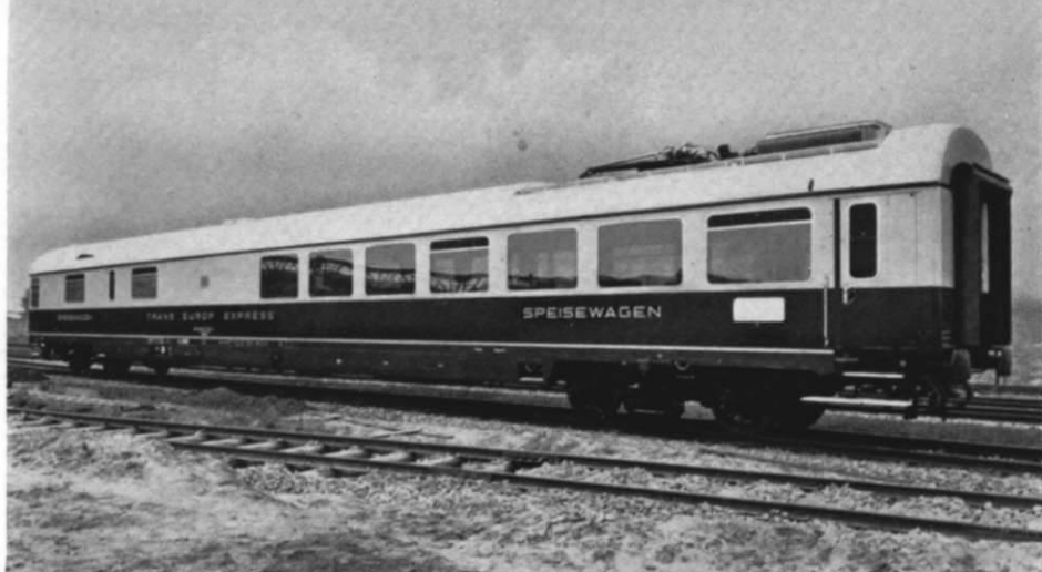
Abb. 1. Vollelektrischer Speisewagen WR ümz mit Einbein-Stromabnehmer.
