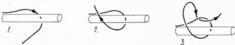
Abb. 10. Mit solchen Knoten bindet man fachmännisch Kabelbäume ... meint unser Mitarbeiter Ruffi und bindet die Kabelbäume bei seinen Anlagen auch wirklich so (siehe Abb. 12—14).
