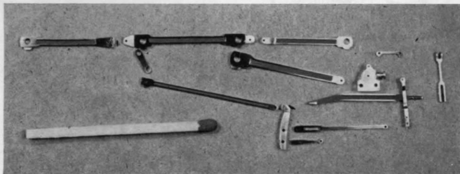
Abb. 13. Die fein gearbeiteten Steuerungsteile aus Dural; als Größenvergleich ein normales 4,5 cm langes Streichholz.
