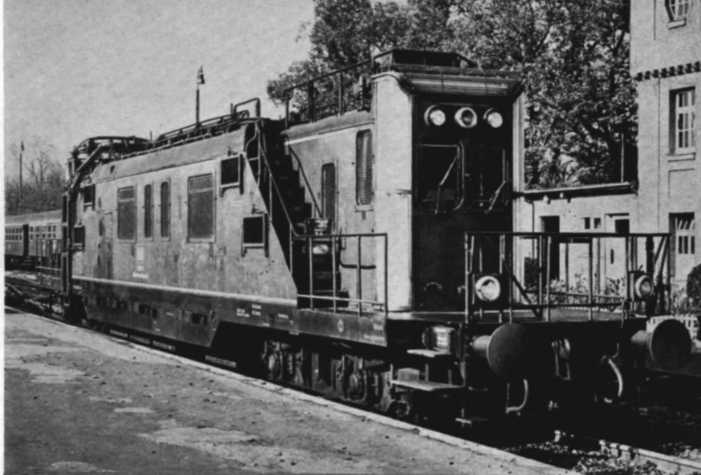
Abb. 3. Das andere Ende des Tunnel-Untersuchungswagens sieht zwar ähnlich aus, jedoch ist hier kein Stromabnehmer überm Führerstand und kein Lichtraum-Profilgestell vorgesehen. Man beachte die umgelegten Geländer (siehe in diesem Zusammenhang Zeichnung Abb. 4).
