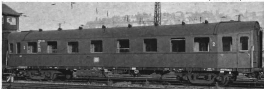
Abb. 5. Hier präsentiert sich die Gangseite eines gleichaltrigen Wagens höherer Komfortstufe. Die beiden mittleren Abteile waren ehemals 1. Klasse, die übrigen 2. Klasse alter Ordnung; rechts das besagte Halbabteil. (Foto: Willke)
