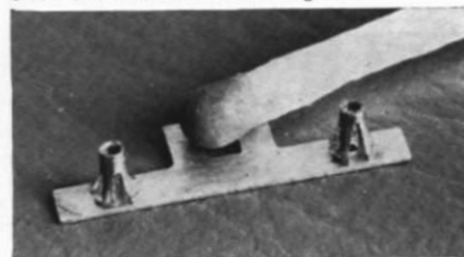
▲ Abb. 7. Eine vorgearbeitete Pufferbohle. Bohrung in der Pufferhülse 0,8 mm
