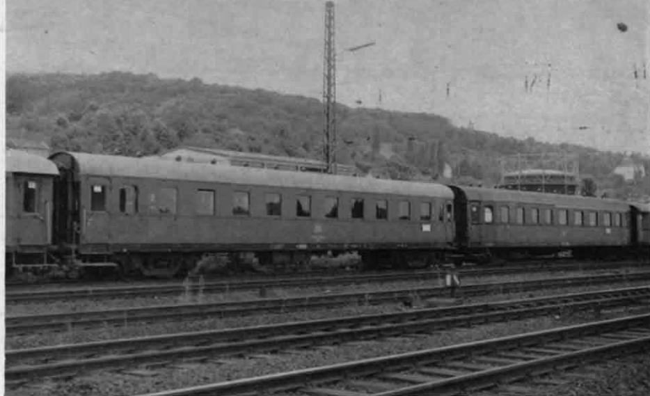
Abb. 10. Bei diesen Wagen handelt es sich nicht — wie der Einsender und Fotograf (Herr H. Kurscheid, Bad Godesberg) vermutet — um Einheits-Schnellzugwagen, sondern wieder einmal um Wagen östlicher Bauart, von denen sich noch eine große Zahl bei der Bundesbahn befindet, die jedoch meist nur in Sonderzügen eingesetzt werden. Die echten deutschen Einheitswagen sind inzwischen sehr rar geworden und nur noch selten anzutreffen.
