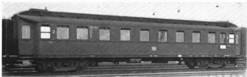
Abb. 1. Erster preußischer Wagen eiserner Bauart aus dem Jahr 1911 — C4ü-Pr 11 —, der sich äußerlich von den herkömmlichen Wagen hauptsächlich durch das fehlende Sprengwerk unterscheidet. (Foto: Willke)
