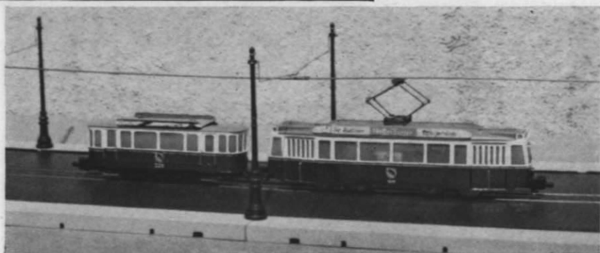
Abb. 6. Aus Ms-Blech und Holz baute Herr Rieß aus Nürnberg diesen TW 175 nebst BW 231 der Straßenbahn Bern (SVB). Der Triebwagen hat ein HAMO-Triebwerk (neuerdings verlegt sich auch Herr Rieß auf N-Motore oder Brawa-Triebeinheiten (Schienenbus). — Abb. 7. zeigt den TW 42 und BW 147 der Heidelberger Straßen- und Bergbahn als H0-Modell des Herrn Rieß.
