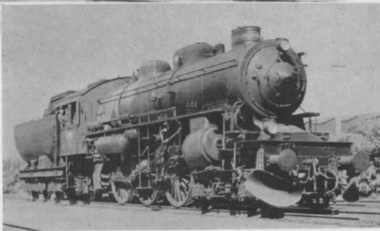
Abb. 1. Die Lok Nr. 998 der Reihe E der Dänischen Staatsbahn; der Wannentender ist auf diesem Bild besonders deutlich zu sehen.
