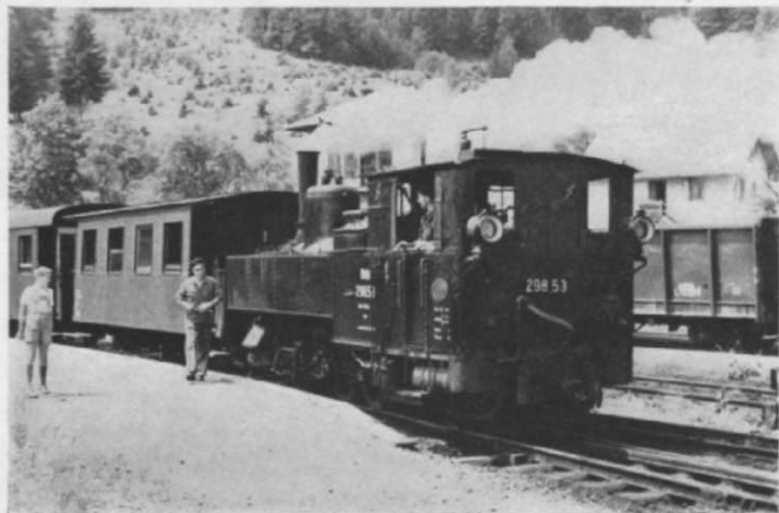
Abb. 6. Auch eine Lok der Reihe U: die 298.53 (ex NÖLB-U 3, Baujahr 1898) im Bf. Klaus der Steyrtalbahn (Spurweite 760 mm).
