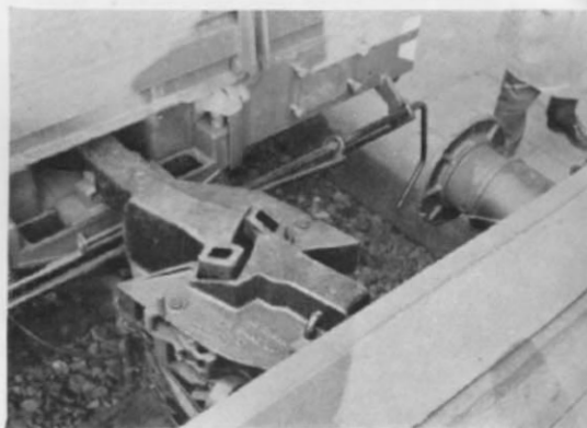
Abb. 6. Unicupler mit Hilfskupplung (Spezialschraubenkupplung) nebst Puffern, wie sie während der Umstellungszeit als Übergangslösung üblich sein wird.
