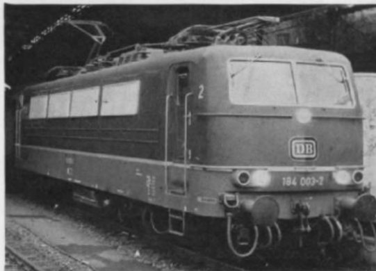
Abb. 1. Viersystem-Eloks 184 (E 410) der Deutschen Bundesbahn im Hauptbahnhof Aachen vor einem Personenzug.
