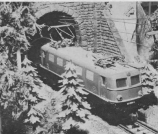
Abb. 10. Das modifizierte Märklin-Modell 3037 (E 10) ohne obere Regenrinne und mit neuer Kennzeichnung.
