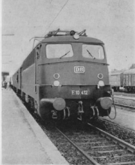
▲ Abb. 4. Eine „110“ mit ringsumlaufender oberer Regenrinne als Vergleich zu Abb. 3 (vor einem Nahverkehrszug im Bahnhof Geilenkirchen).
