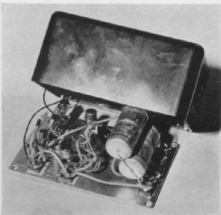
Abb. 2. Die Innereien des Effektivwertkonstanters (an vorhandenen Trafo anzuschließen).
