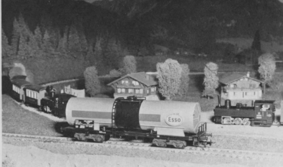
Abb. 135. Der vierachsige Heizöl-Transportwagen in H0, L6P 17,2 cm, mit rotem Längsband und schwarzem Mittelteil, mit ESSO- und SHELL-Schildern erhältlich.
