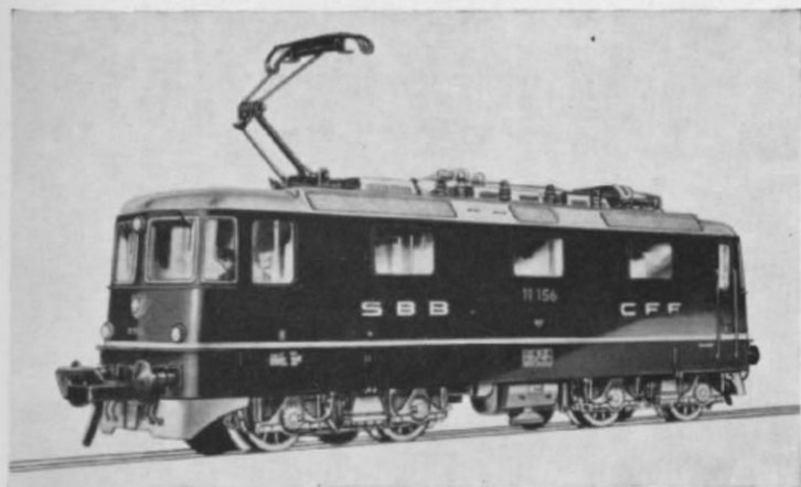
Abb. 53. Der Deutlichkeit halber noch ein Fleischmann-Bild von der Re 4/4 II, auf dem diverse Details und Feinheiten besser erkennbar sind (einschließlich dem Lokführer, der im Hinblick auf den SBB-Linksverkehr auf der linken Lokseite sitzt).
