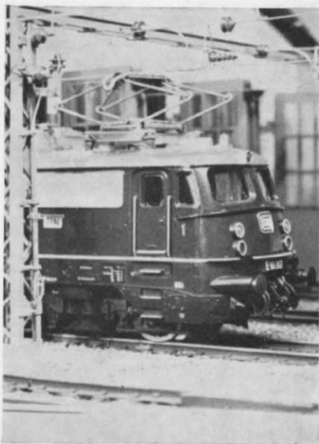
Abb. 4 zeigt eine Fleischmann-E 10 in der Tordurchfahrt meines Heizhauses. Die Lok ist auf einer Seite wiederum mit Kupplung und Bremschlauch-Attrappen ausgerüstet. Das Schallgerüst der Fahrleitung wurde dem des Heizhauses Wörgl, dem ich übrigens als Lokführer angehöre, nachgebaut. Man beachte das Schallgestänge und den Trennschalter am Mast samt zugehörigem Trenner in der Fahrleitung! Der Schallzeiger zeigt auf dem Bild „EIN“ und in abgeschaltetem Zustand Signal 77 (DB = E 16). Das Schallgestänge samt Drum und Dran ist nur eine Attrappe. Die Fahrleitung besteht aus 0,4 mm Bronzedraht der Fa. Memoba Wien und wird möglichst originalgetreu verspannt. Die „Messing“-Isolatoren beziehe ich ebenfalls von dieser Firma. Die Maste, Gerüste und dergl. sind größtenteils auf Nemec-Profilen gebaut.
