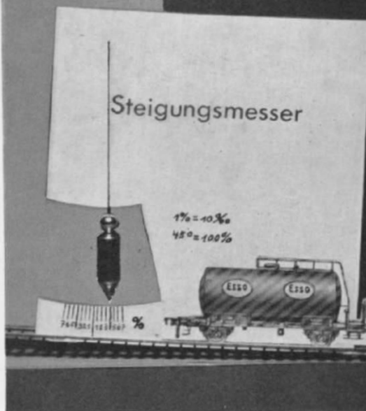
Chronos' Steigungsmesser — eine einfache, jedoch wirkungsvolle und keineswegs „unnütze“ Vorrichtung.
