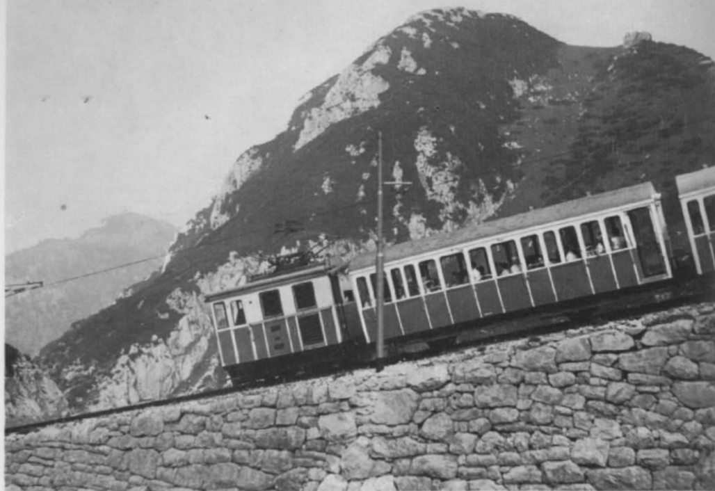
Abb. 7. Ein nettes Bild von einer anderen bayer. Zahnradbahn, der Wendelstein-Bergbahn. Lok und Wagen sind noch kürzer und noch schmucker im Aussehen. Einen Motor nebst Zahnrad-Getriebe in der kleinen Lok unterzubringen, dürfte sehr schwer sein; leichter ist es jedenfalls, einen flachen Motor im nachfolgenden Personenwagen anzuordnen, wobei man darauf bedacht sein sollte, die freie Fensterdurchsicht zu wahren!
