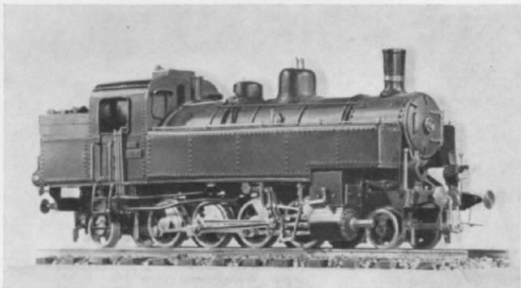
Abb. 2. Ein akkurates H0-Modell einer österr. 1'D1'-Dampflokomotive des Herrn Dr. K. Wimmer vom MEC Linz.
