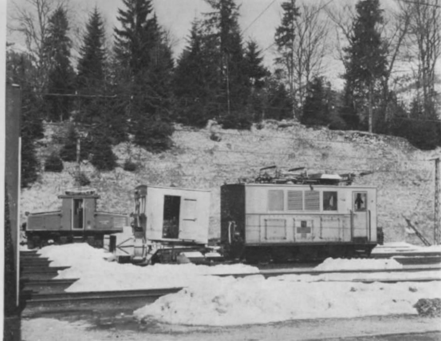
Abb. 1. Lok Nr. 16 mit der einachsigen Schneeschleuder vor der Wagenhalle in Grainau. Im Hintergrund eine zweiachsige Adhäsionslok.
