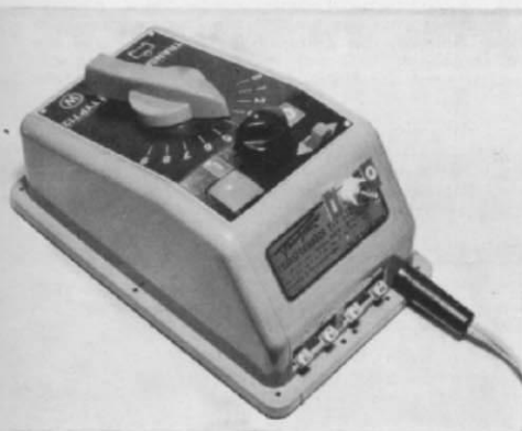
Abb. 14. Die endgültige Ausführung des Fleischmann-Fahrpultes. Deutlich zu sehen ist der zusätzliche Regler und, wie beabsichtigt, kaum sichtbar der mit schwarzer Selbstklebefolie abgedeckte Firmenaufdruck. (Der Schalter auf der abgegrängten Vorderseite stammt von einem anderen Versuch und hat mit unserem Umbau nichts zu tun).
