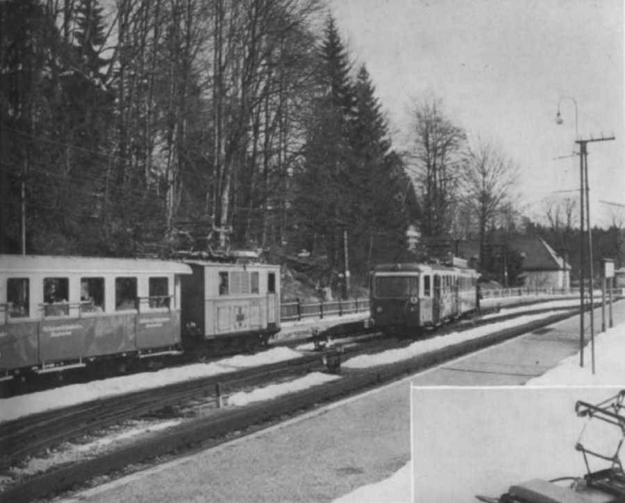
Abb. 3. Lok Nr. 15 an Ostern 1967 im Systemwechselbahnhof Grainau - Badersee. (Rechts nach Garmisch-Partenkirchen, links Ausfahrt in Richtung Eibsee). Von den 4 Wagen des Talzuges aus G.-P. gehen an einem solchen Tag drei auf die Zahnradbahn über (einer als Beiwagen des TW, zwei mit der alten Lok als Nachzug auf Sicht, ohne jegliche Blocksicherung).
