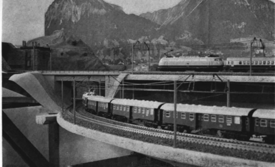
Abb. 11. Auch dieses Bild von dem modernen Unterführungs-Bauwerk, das bestimmt ebenfalls dem großen Vorbild abgeschaut ist, sagt einiges über Anlagenbauweise und Geländegestaltung aus. Gut erkennbar durch den fahrenden Zug: die vorgenommene Gleisüberhöhung.
