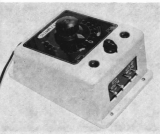
Abb. 9. Das umgebaute und (mittels M 2,5-Schrauben) wieder zusammenmontierte Trix-Fahrpult — jetzt mit stufenlos einblendbarem Rangiergang. Der zusätzliche Reglerknopf liegt griffgünstig auf der Oberseite des Geräts. Null- und Endstellung können noch mit S (Streckengang) und R (Rangiergang) gekennzeichnet werden.
