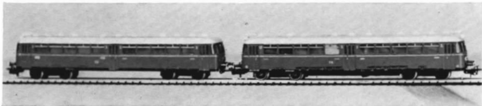
Abb. 8. Akku-Triebwagen ETA 150 mit ESA 150 als H0-Modell des Herrn Ulrich Stade, Hannover, gebaut aus 4 Gehäusen des Märklin-Schienenbusanhängers, Antrieb (Marx-Milliperm) auf zwei Achsen.
