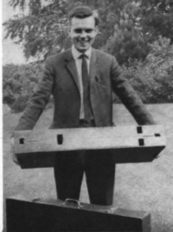
Abb. 9. Die Aussparungen in der Rückwand des kleineren Koffers (s. a. Abb. 3). Die Gleisübergänge müssen natürlich haargenau spuren! Die Scharniere dürfen kein Spiel haben.
