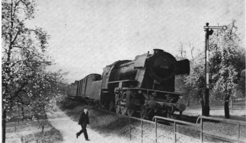
Abb. 6. Ein Beispiel für eine ziemlich starke Überhöhung beim großen Vorbild, obwohl der Kurven-Radius anscheinend doch recht groß ist. Wie Signal, Gelände und Baum (links) erkennen lassen, handelt es sich keineswegs um eine optische Verzeichnung durch die Kameralinse!
