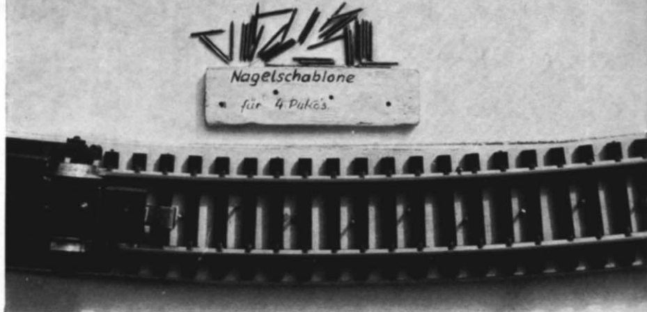
Abb. 4. Eine Nagel-Schablone für 4 Pukos. Das Gleis ist provisorisch auf das Böschungsteil mit den eingepreßten Pukos gelegt, um eine Probefahrt durchführen zu können.
