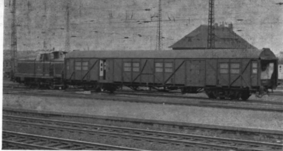
▲ Abb. 3. Autotransport- Wagen. Merkmale: Vor- bauten über den Puffern, große Stirnwandtüren und Gummi- wulste.
