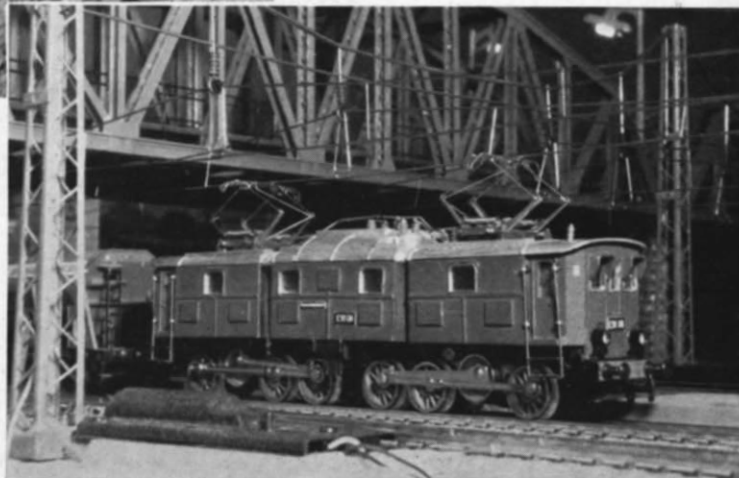
Abb. 9. „Opus 1“ nennt Herr Udo Barthold, Langeoog, sein H0-Modell von der E 91, das aus 2 Fahrwerken der Märklin-E 63 entstand, deren Räder radspeichenisoliert wurden. Es war sein erster Selbstbau-Versuch — aber nicht sein letzter, wie er schrieb.
