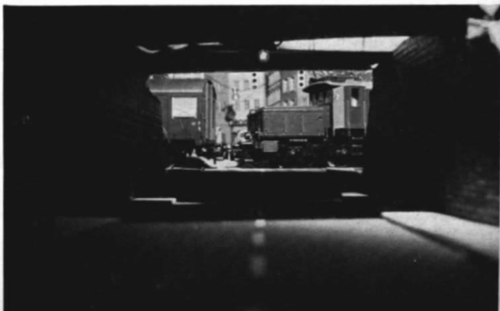
◀ Abb. 5. Die ganze Art der Gleis- und Weichenanordnung (einschließlich der Unterführung) verraten den Kenner (der Materie)! Ein Teil der Gleise besteht aus Peco-Puko-Gleisen und im Bereich des Bws sind nach MIBA-Anleitung Nägel als Mittelleiter eingeschlagen. Gefahren wird mit Dreischienen-Gleichstromsystem.
