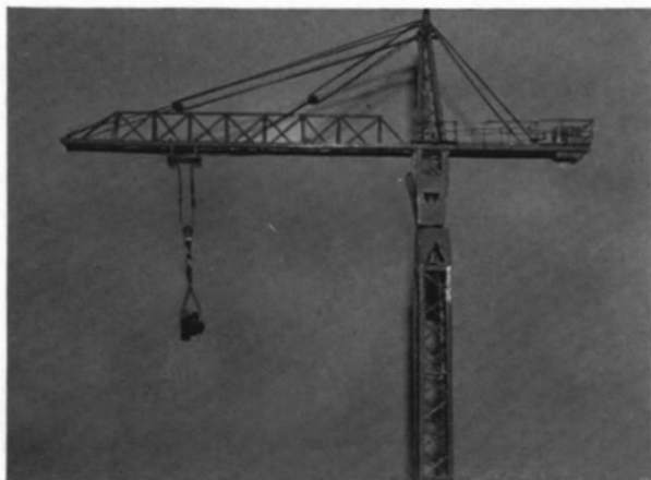
Abb. 6. Der große Baukran von Abb. 5 nochmals nah besehen. Herr Tripp baute ihn aus Alu-Blech und Draht. Der Ausleger ist um 360^\circ drehbar und die Laufkatze kann unter dem ganzen Ausleger bewegt werden. Die rote Warnlampe ist beleuchtet und das Schutzgelenk aus 0,15 mm „dickem“ Draht.
