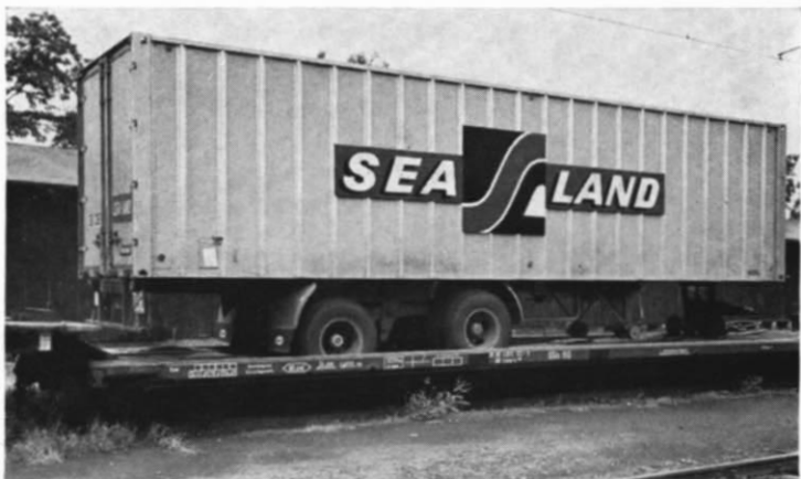
Abb. 38 (Mitte). Ein 35 Fuß-Container mit Straßenchassis auf einem Niederflurwagen „Aachen“, von dem wir auf S. 514—17 eine Bauzeichnung bringen.
