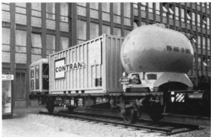
Abb. 39. Eine gemischte Beladung eines modernen Behälter-Tragwagens mit zwei pa-Behältern und einem 20'-Container — eine Möglichkeit, die Modellbahner vielleicht besonders anspricht.
