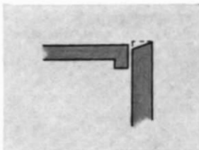
Abb. 3. Die Alternativlösung: Seitenwand (bis ungefähr zur Schrägwand) nach innen abschärfen (in der Zeichnung übertrieben dargestellt).
