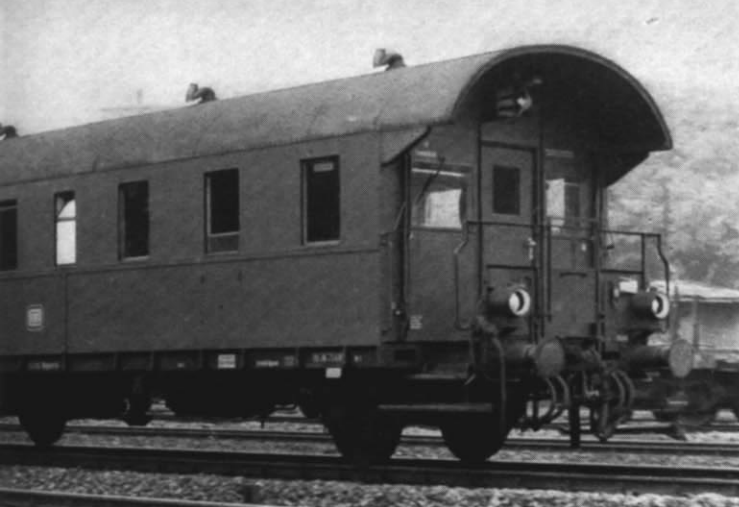
Abb. 3. Der besagte zweiachsige DB-Versuchssteuerwagen. Das Signalhorn ist (wie auch in Abb. 2 gezeichnet) unterm Dach neben der dritten Laterne angeordnet. Beim Modell wurde zur deutlicheren Kennzeichnung des Steuerwagens das Horn (übrigens aus dem Schiffsmodellbau) bewußt auf das Dach gesetzt. Ggf. sind gelb-schwarze Eckstreifen und weißer Pufferwarnanstrich weitere Mittel zur Markierung des Steuerwagenendes.
