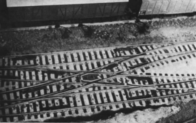
Abb. 19. Eine von Herrn Fritsch selbstgebaute doppelte Gleisverbindung, die auf Grund des übrigen Märklin-Materials mit Pukos gebaut werden mußte. Die Pukos sind Nägel, die in einen Messing-Streifen, der unter den Schwellen liegt, eingeschlagen werden. Herr Fritsch bestätigt, daß diese in der MIBA mehrfach beschriebene Methode tatsächlich beste Ergebnisse (= einwandfreie Stromverbindung) zeitigt, obwohl kein einziger Puko angelötet zu werden braucht.
