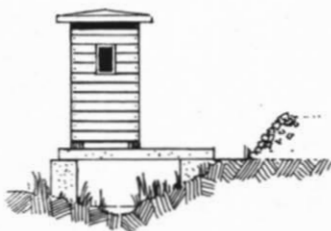
Abb. 5. Eine Version von Abb. 2: zwei Pfeiler 4 mm □ und eine Betonplatte, die dämmsseitig auf einer Betonswelle aufliegt. Die Fernsprekbude ist bei diesem Pit-Peg-Vorschlag in Holz ausgeführt.
