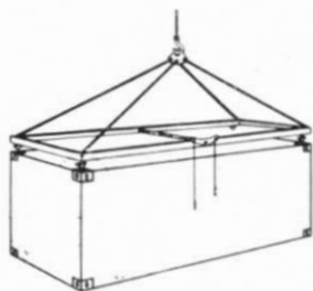
Abb. 18. Vorteilhafter ist ein solches Rahmengeladegericht, bei dem die Tragelemente in die oberen Eckbeschläge eingreifen, aber immer noch besteht das Handicap, der Drehbewegung am Kranhaken irgendwie Einhalt gebieten zu müssen.
