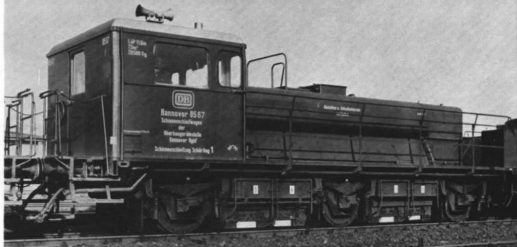
Abb. 1. Das Vorbild der heutigen Bauplan-Zeichnung: Schienenschleifwagen der Bauart Schörling.
