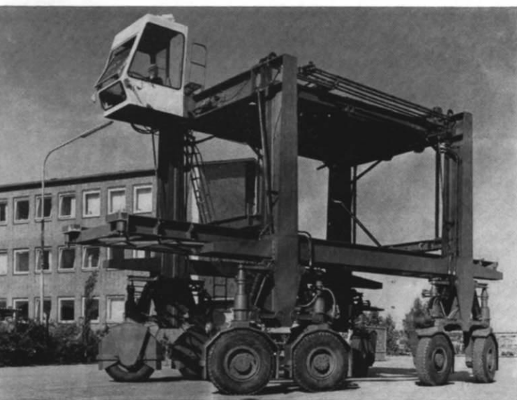
Abb. 13. Der Portal-Hubwagen (Van-Carrier) der Peiner Maschinen- und Schraubenwerke AG, Peine, dessen Nachbildung im kleinen wir uns von Wiking erhoffen. Solche Portal-Hubwagen sind auf den großen Hafen-Liegeplätzen eingesetzt, wo sie die mittels Großkranen aus dem Schiff abgesetzten Container aufnehmen und zum Sammelplatz bringen bzw. auf Eisenbahnwagen verladen.
