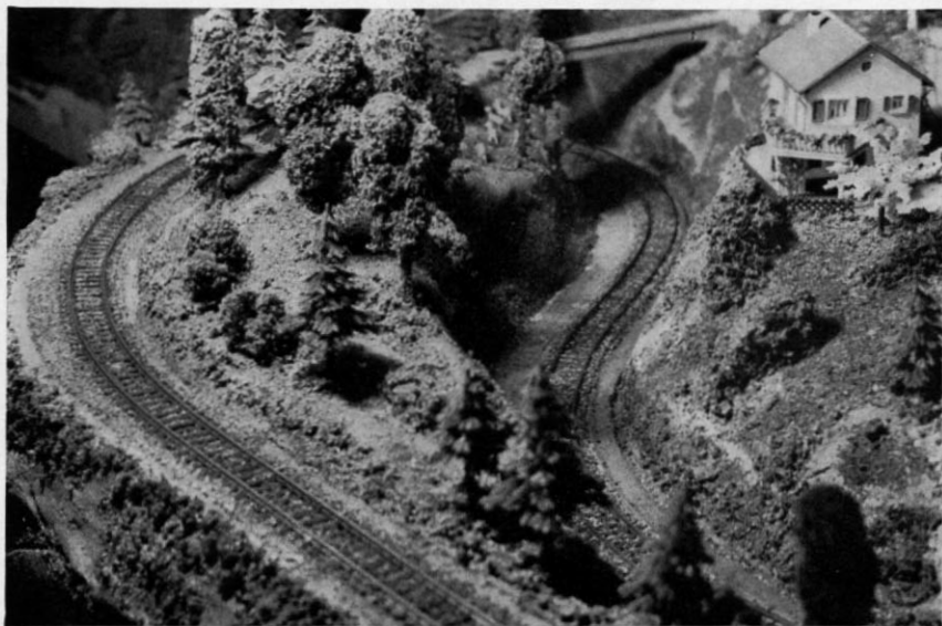
Abb. 3. Auch dieses Bild stammt von Herrn Geiger und soll zeigen, wie unauffällig Puko-Gleise — gleich welchen Fabrikats oder als Eigenbau — wirken können, wenn sie geschickt verlegt (eingebettet) und die Puko-Stifte so unscheinbar wie nur möglich ausgeführt sind!
