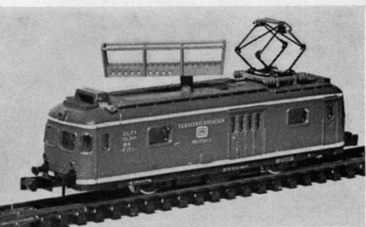
Abb. 15. Turmtriebwagen VT 93 mit beweglicher Arbeitsbühne und Scherenstromabnehmer.
