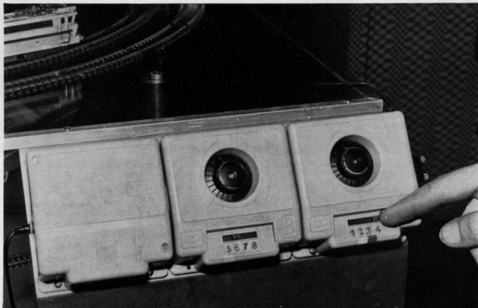
Abb. 95. Der Wechselstrom-Trafo und die beiden Fahrtregler mit den 8 wahlweise einstellbaren Generatoren des JOUEF-Mehrzugsystems, bei dem jedoch zur gleichen Zeit nur jeweils 2 Loks unabhängig voneinander fahren können! Der Vorteil liegt bei diesem System zweifellos im Fortfall von getrennten Stromkreisen und deren Verdrahtung.
