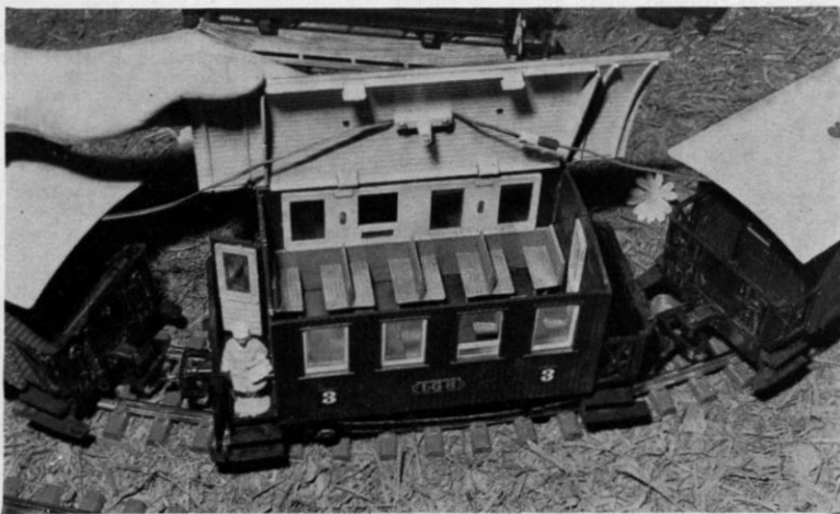
Abb. 119. Blick ins Innere eines beleuchteten Personenwagens. Sämtliche Türen sind beweglich und das Dach ist abnehmbar. – Abb. 120. Blick unter einen der Wagen. Die Achslagerböcke sind mit der Kupplung kombiniert und drehbar gelagert. Der Kupplungshaken ist wegen der engen Radien nur einseitig angebracht und sicher in der Funktion. Eine Fernentkupplung ist geplant.
