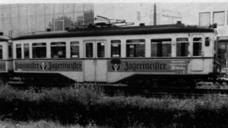
Abb. 6. Seitenansicht des Steuerwagens. Der Motorwagen sieht äußerlich genau so aus, bis auf die Dachpartien mit den Anfahr- und Bremswiderständen (s. Abbildung 4).
