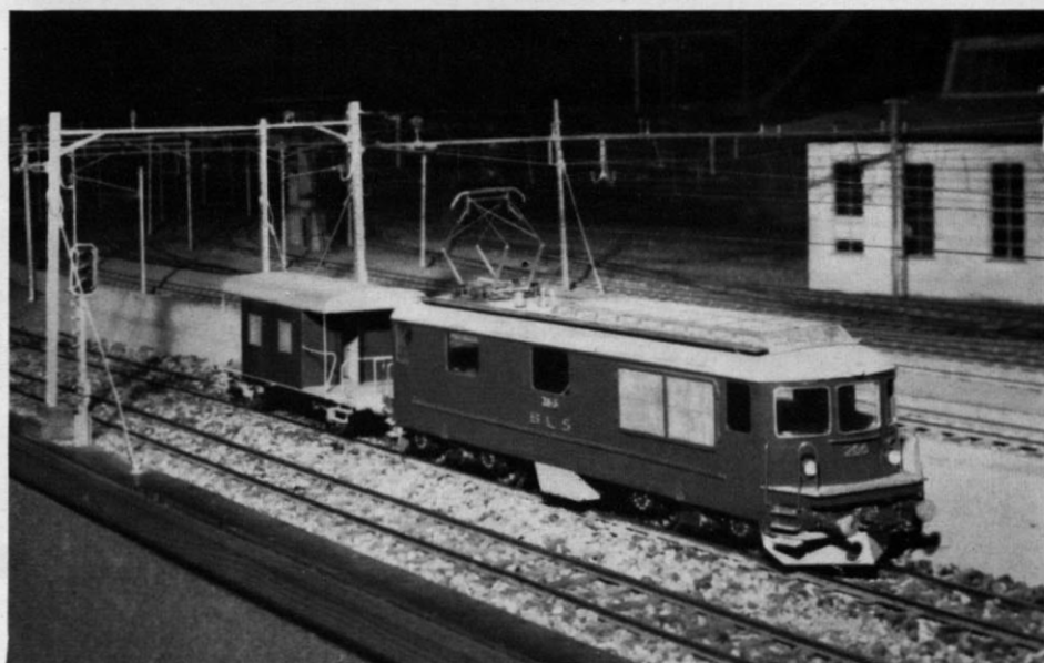
Abb. 3 (unten). Die zweite, von Herrn Gysin in Größe I gebaute SBB-Elllok, die Re 4/4, ebenfalls auf der Spur I-Anlage des MCB. Gewicht besagte 6 kg (zum 60.), L ü P 48,5 cm.
