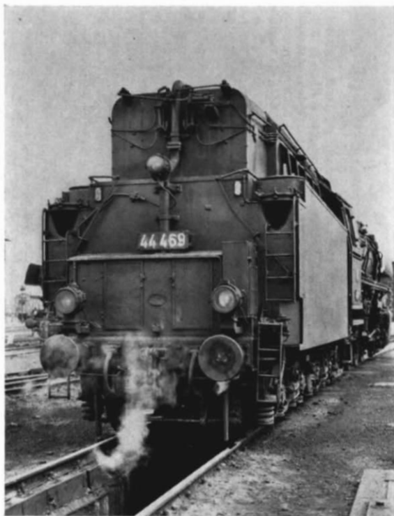
Abb. 11. Die Tenderrückseite der ölbefeuerten 44 469; sie scheint gleich zu sein wie die der 01 10 (s. Abb. 9), doch sind bei genauem Vergleich der Fotos und der Zeichnungen gewisse Unterschiede erkennbar, die bei einem Miniaturnachbau berücksichtigt werden sollten, z. B. breiter und am Ende konisch auslaufender Aufbau, unterschiedliche Details in der Draufsicht, andere Leitern, etwas überstehende Wassereinfüllstutzen und — selbstverständlich — ein anderes Loknummernschild!
