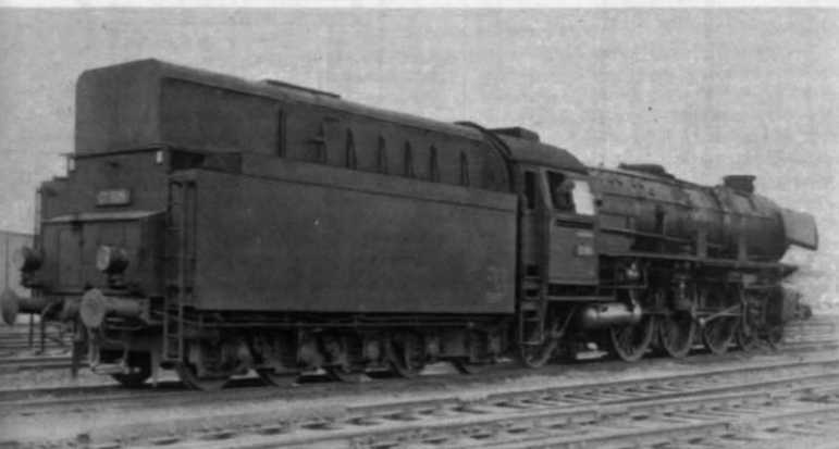
Abb. 3. Die Tenderausführung der ölbefeuerten BR 01 1105, die ob ihrer einfachen, glatten Flächen manchem Modellbauer mehr zusagen mag als z. B. der reichdetailierte Tender der nachstehenden BR 01 1001. (Foto: Lokbildarchiv Bellingrodt)
