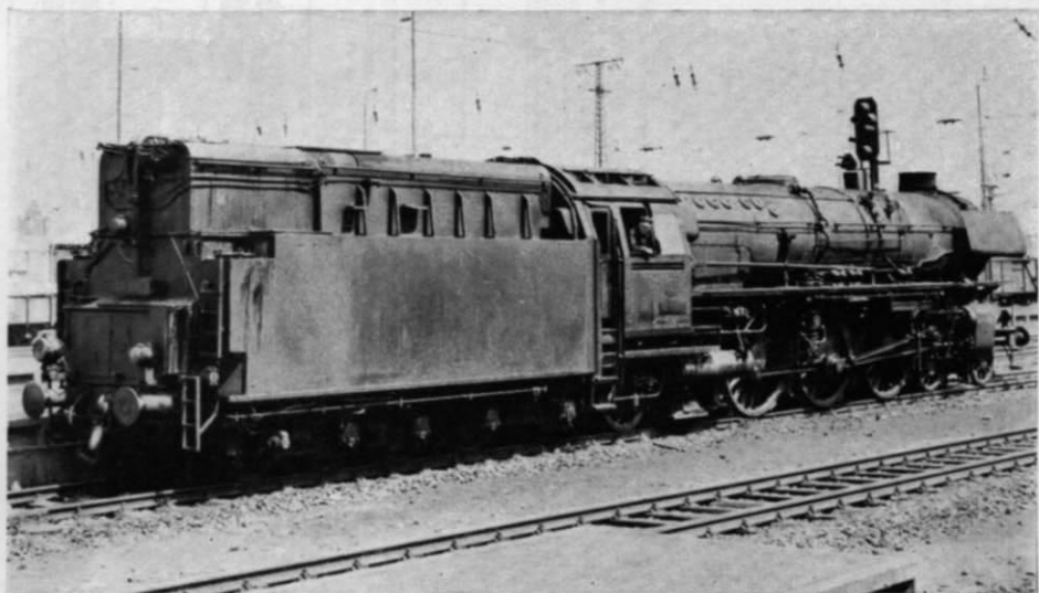
Abb. 4. Die ölbeheizte BR 01 1001. Deutlich erkennbar der große Schornstein, der Dom-arme Kessel und der Tender mit seinen charakteristischen Details (s. a. Abb. 6—9).
