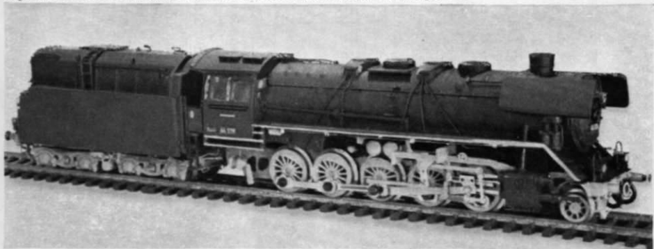
Abb. 5. H0-Modell der ölbeheizten BR 44 528, gebaut von Herrn J. Rudolph, Holzgerlingen, aus einem abgeänderten Gehäuse der Piko-BR 50 und einem Triebwerk der Hruska-„84“.
