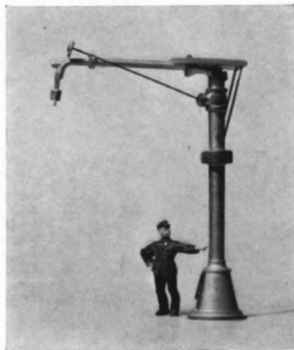
Abb. 6 u. 7. Ein drehbarer, wasserkränähnlicher Dieseltankanschluß, wie er in Amerika häufig anzutreffen und als H0-Bausatz-Modell über die Fa. Old Pullman zu beziehen ist. Bei uns werden ähnliche drehbare Zapfsäulen vornehmlich zum Betanken der öl-befeuerten BR 01 und 44 benutzt. Im Bild rechts ist eine solche Säule (im Bild-Verkleinerungsmaßstab der Baugröße N entsprechend!) im Bw Bebra zu sehen. Im Hintergrund zwei große Öltanks mit je 350 t Fassungsvermögen.
