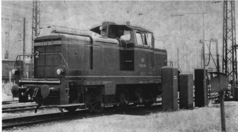
Abb. 12. Nichts weiter als 3 rote Zapfsäulen und ein schwenkbarer Ausleger mit Schlauchanschluß sind von dieser Dieseltankstelle zu sehen, die Herr J. Zeug aus Trier im Gelände des Münchner Hbf. fotografierte. Im Bereich der Zapfsäulen ist auch hier ein ölabweisendes Betonfundament vorgesehen.
