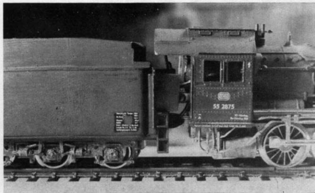
Abb. 13. Nach erfolgtem Umbau: die von Herrn Henning auf das Märklin-System ummodelte Fleischmann-„55“, hier noch mit einem provisorisch aufgesetzten verkürzten Tender-Gehäuse der BR 01 (das in Höhe der Bürstenführung nach Entfernen der Wandverstrebungen innen noch etwas schmaler gefeilt werden mußte). Später soll es zwar durch ein selbstgefertigtes ersetzt werden, das aber schon des Radstandes wegen „niemals nicht“ dem Fleischmann-Tender entsprechen kann. Auch in diesem Punkt ist der Lösung des Herrn Körrer der Vorzug zu geben. (Fotos Abb. 11-14: D. Henning)
