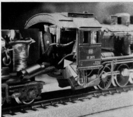
▲ Abb. 11. Das Original-Triebwerk der Märklin „3067“, von Herrn Henning als Tender-Antriebseinheit der Fleischmann „55“ verwandelt. Das neue Tendergehäuse wurde mittels einer Schraube durch eine Bohrung in der Kohlen-Imitation an einem aufgeklebten Holzklötzchen befestigt (s. Pfeil links oben). Zwischen Fahrwerk und Feldmagnet hat Herr Henning mit UHU-plus ein dünnes Sperrholzblech geklebt (s. Pfeil rechts unten), das eine Bohrung zur Befestigung der Kupplungsstange erhält.
