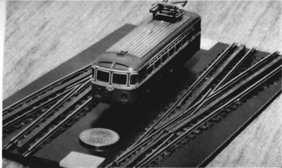
Abb. 1. Zwei der von Herrn Gerke gebauten Zahnradbahn-Weichen mit 12 mm Spurweite; rechts die der Abbildung 2 bzw. 3 entsprechende Ausführung nach dem Vorbild der Drachenfels-Bahn.
