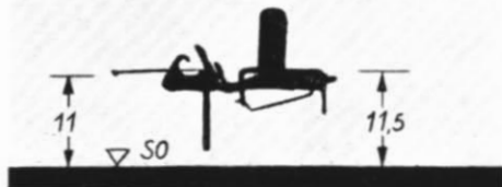
Abb. 1. Die i-Kupplung in \frac{1}{4} natürlicher Größe mit Angabe der beiden wichtigen Hauptmaße, auf die es bei Einbau und Einstückung ankommt: 11 mm von Schienen-Oberkante (SO) bis Unterseite Bügelmitte, 11,5 mm von SO bis Oberseite Befestigungsplatte.
