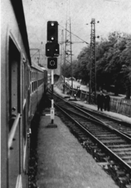
Abb. 9. Ein Signalkuriosum besonderer Art: Österreichisches Haupt- und Versuchs-signal am gleichen Mast mit einem deutschen Zusatzsignal Zp 9 (Abfahrauftrag) – fotografiert im Bahnhof Kufstein von Herrn Ing. Oskar Schneider, Wien.
