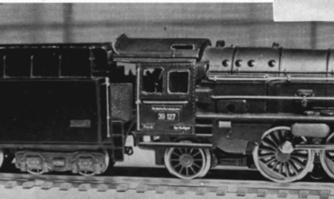
Abb. 8 u. 9. Die Kurzkupplung bei der BR 39 (preuß. T 10), die von der Fa. K. Schieck, Stuttgart, aus der Märklin-„01“ in Kleinserie hergestellt wird (s. a. Heft 2/XVIII, S. 53). Zwei am Tender befestigte elastische (Gummi-)„Türen“ schließen die Lücke zwischen Tender und Führerhaus und beeinträchtigen in keiner Weise die Kurvengängigkeit. (Foto: MIBA)
