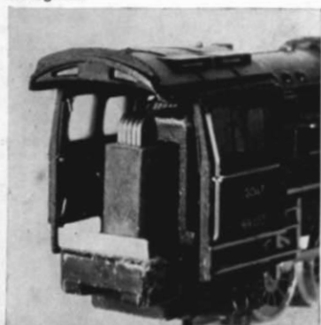
▲ Abb. 5. Der Tenderboden der „44“ nach erfolgtem Umbau: alte Verbindungsstange (bis auf das schon erwähnte kurze Reststück) entfernt und neue Stange angebracht; die ca. 5 mm lange Zugfeder zwischen Zunge im Tenderboden und Verbindungsstange ist bereits eingehängt und der Tenderboden am vorderen Rand (rechts) glatt gefeilt. (Fotos: Elsner)
