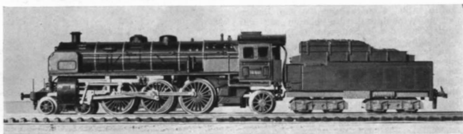
Abb. 11 u. 12. Aus gutem Grund bringen wir die Konterfeis kurzgekuppelter Trix-S 3/6 zweimal: Im Bild oben betrgt der Spalt (nach Krzen des Tenderrahmens vorn um ca. 5 mm, Absgen der Leiter am Tender und Wegfeilen von strendem „Fleisch“ am Fhrerhaus) nur noch etwa 2 mm, aber trotzdem ergibt sich noch kein geschlossenes Bild von Lok und Tender; letzterer wirkt immer noch wie ein angehngter Wagen, was einzig und allein auf den noch vorhandenen (wenn auch wesentlich kleineren) Spalt zurckzufhren ist. In der unteren Abbildung ist auch dieser verschwunden, und zwar durch Einsetzen von „Tren“ aus federnder Phosphorbronzefolie (in Handwerksbedarfsgeschften erhltlich). Die Tren, etwa 25 mm lang, werden an der Tender-Innenseite angeklebt; sie biegen sich auch in Gegenkurven durch. Erst jetzt ergibt sich ein geschlossenes Gesamtbild (entsprechend Abb. 13), das durch Einkleben eines dunklen Schaumgummistckchens (ungefhr in Kupplungshhe) noch vervollkommen wird. Ist es nicht erstaunlich, welche verblffende Wirkung so ein kleines Stckchen Blech haben kann?!
