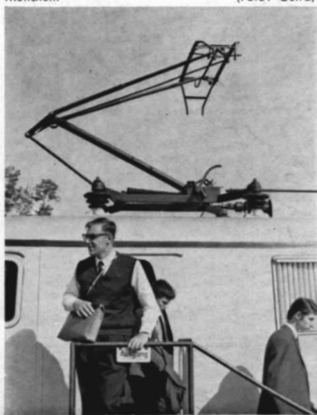
Abb. 2. Der Einholm-Stromabnehmer bei der Original-E 03, erstmals zu sehen auf der IVA 1965 in München. (Foto: Ostra)
