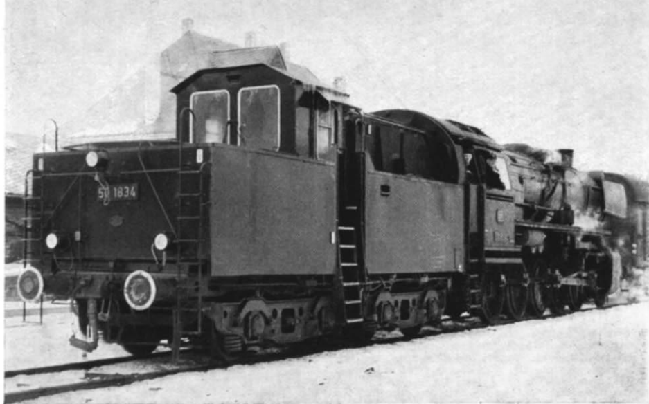
▲ Abb. 12. Einer der 700 Kabinentender des großen Vorbilds, hier an einer BR 50 im Bahnhof Rennerod im Westerwald. Der Ausführung dieses in des Wortes wahrster Bedeutung „bilschönen“ Tenders entspricht die Zeichnung Abb. 10.
