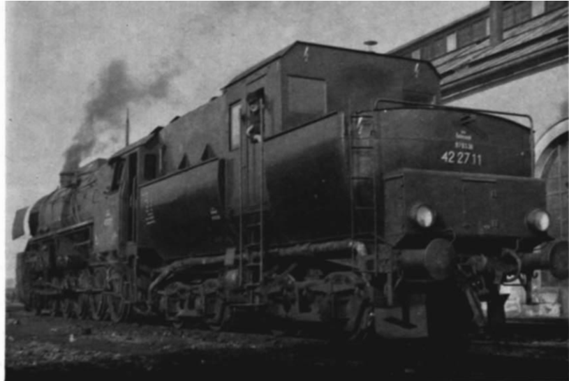
Abb. 2. Neben der Lok BR 52 werden in Österreich auch die Wannentender der BR 42 mit Zugführerkabinen ausgerüstet (s. a. Heft 1/XV, S. 5). Die Trix/Rivarossi-42, auf deren Wannentender die Übersichtszeichnung Abb. 3 maßlich abgestimmt ist, läßt sich also durchaus vorbildgemäß in eine Lok mit Kabinentender umbauen. (Foto: Dr. F. Weinhardt, Graz)
