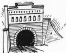
Abb. 3. Ein hochgezogenes Portal mit steilen Stützmauern und angedeutetem romanischen Bogen. Die Detailskizze zeigt die unterschiedlichen Mauerstärken und die Zusammensetzung der einzelnen Partien.
