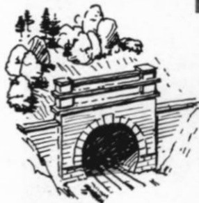
Abb. 5. Eine weitere Möglichkeit der Portalgestaltung durch eine „doppelstöckige“ (als Gröllschutz dienend) Bewehrung der Tunneleinfahrt. Eine Variante ergibt sich durch Weglassen des oberen Mittelstücks.
