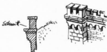
Abb. 7. Ein vielleicht etwas südländisch anmutendes doppelgleisiges Tunnelportal mit strenger senkrechter und waagerechter Linienführung. Detailskizzen und Schnittzeichnung erleichtern den Nachbau der Zinnen, die man am besten in einem Stück aus einer 2 mm starken Sperrholz- oder Kunststoffplatte aussägt.
