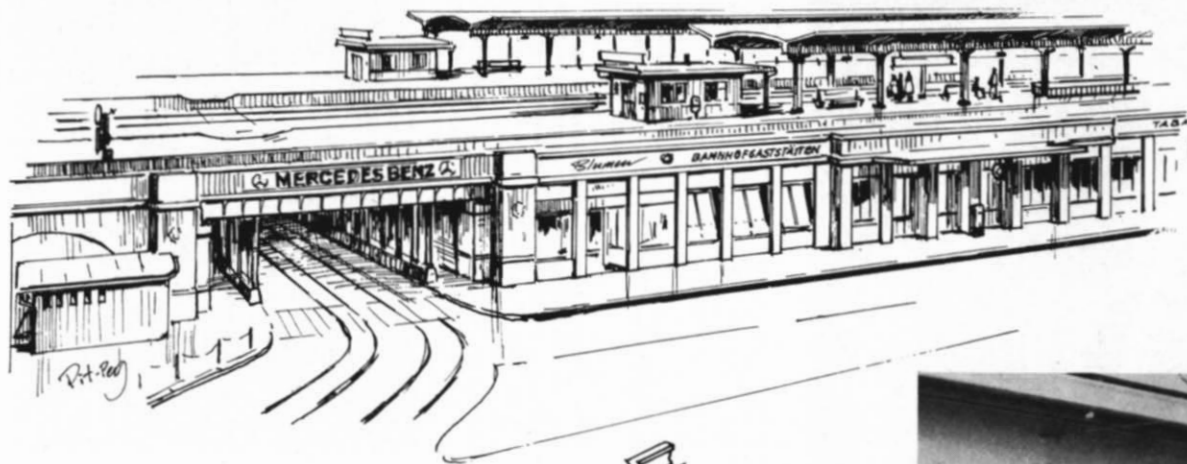
Abb. 45. In dieser oder ähnlicher Form lößt sich ein Bahnhofs-Eingang organisch (und platzsparend) in den Bahndamm einbeziehen. Zeichnung: Pit-Peg
