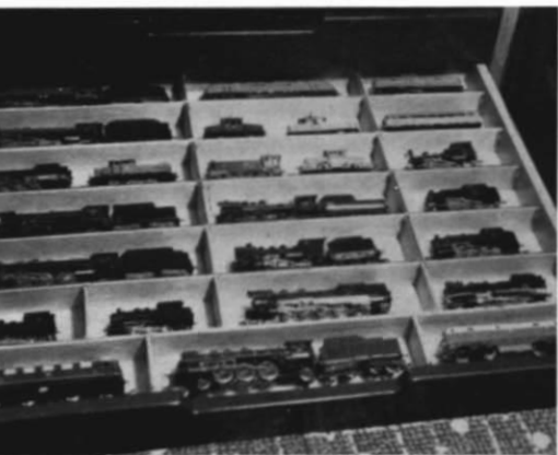
Abb. 4. Eine der 6 cm hohen Schubladen, die mit akkurater Sperrholz-Facheinteilung versehen und zwecks stoßgesicherter Unterbringung der Fahrzeuge mit einer ca. 10 mm dicken Schaumgummischicht ausgekleidet sind. Trotz der geringen Schrankgrundfläche (etwa 90 x 65 cm) finden in den 7 Schubladen rund 30 Loks und 110 Wagen ihren angestammten Platz!
