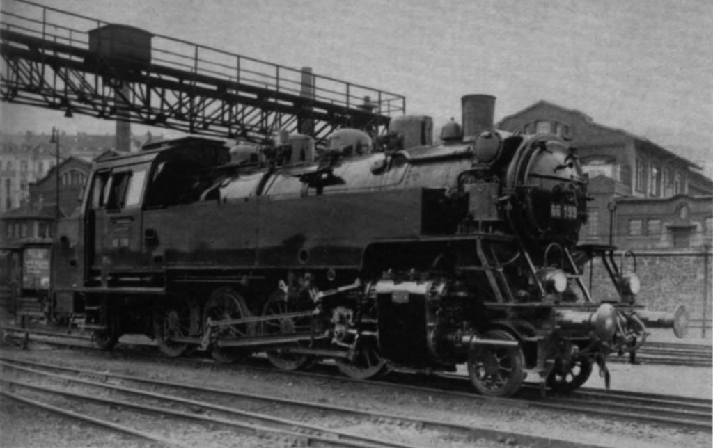
Abb. 1. Eine wuchtige Maschine: die 86 199, die noch zu den älteren Ausführungen mit genieteten Wasserkästen und nur einseitig abgebremsen Kuppelrädern gehört. (Foto: Lokbildarchiv Bellingrodt)
