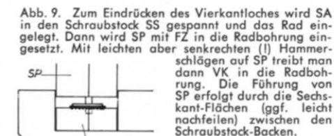
Abb. 8. Werkzeug zum Eindrücken des Vierkantloches in den Radkörper. SP = Stempel aus Sechskantstahl, FZ = runder Führungzapfen (Durchmesser entsprechend Radbohrung), VK = Vierkantzapfen, SA = „Schablonen“-Teil aus Sechskantstahl (Radauf-lage), LK = Ausdrehung auf Laufkranz-Durchmesser, ZR = Zapfen für Radkurbelbohrung.
