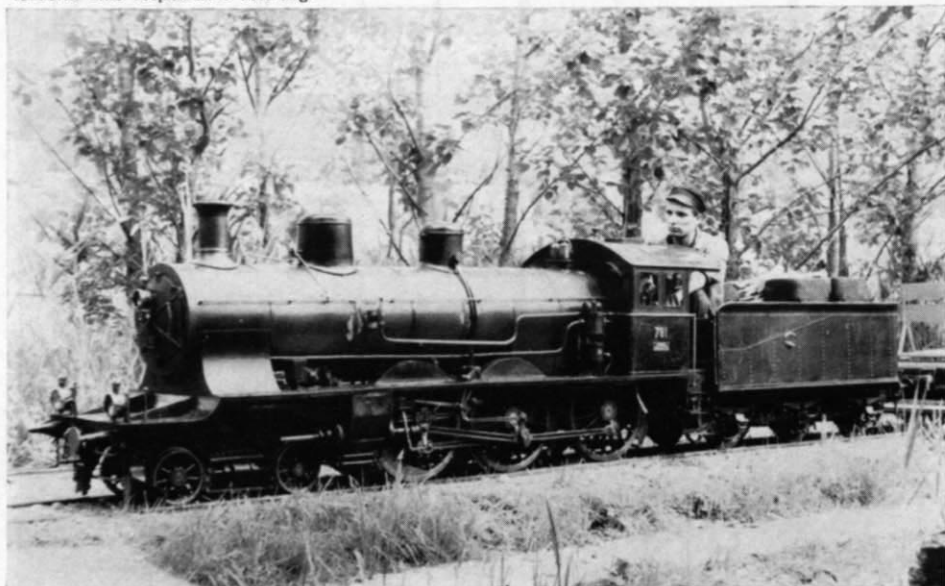
Abb. 11. Der Goliath unter den Mini-Loks: Die 2'C-Lok A 3/5 der SBB im Maßstab 1:4 ist schon ein recht gewichtiger „Apparat“ und kann immerhin einen mit 48 erwachsenen Personen besetzten Zug (3 Wagen) befördern. Eine respektable Leistung!
