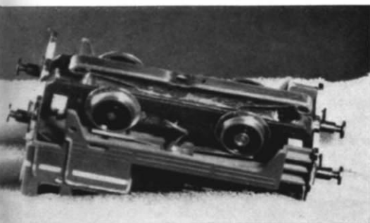
Abb. 19 u. 20. Herr Rudolf Elsner aus Berlin hat sogar die kleine Gültold-Diesellok mit ihrem tiefliegenden Chassis mit einem Schleifer ausgerüstet. Dazu mußte allerdings der Blechboden des Getriebeabdeckbleches herausgesägt und durch ein 0,3 mm starkes Pertinax-Blättchen ersetzt werden, das mit Uhu-plus eingeklebt wurde (Abb. 20). Vom Schleifer wurden die Haltetaschen für dessen Pertinax-Plättchen abgeschnitten und der Schleifer direkt an die neue Getriebeabdeckung geklebt. Die Befestigungsschrauben der Abdeckung sind durch Senkschrauben zu ersetzen. Diese sowie ihre nähere Umgebung sind noch mit Tesafilm als Isolation gegen die Schleiferenden abzudecken.
