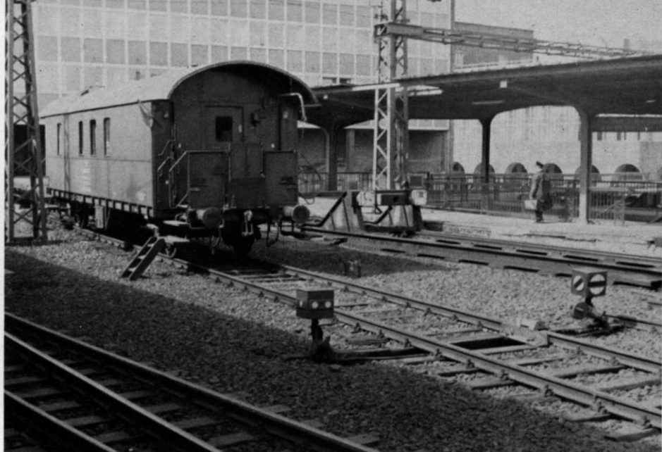
Abb. 1. Diese Gleissperre im Bahnhof Essen hat gleich zwei Gleissperr-Signale, wohl damit sie von den Rangierern auf beiden Seiten eines anrollenden Zuges nicht übersehen werden kann. (Im übrigen sagt die gelbe Flagge an der Wagenstirnwand, daß dieser Wohn- und Werkstattwagen der Fernmeldewerkstatt Neuaubing mit Personen besetzt ist).
