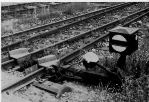
Abb. 2. Eine doppelte DB-Gleissperre mit Handstellhebel. Diese Sperre hat bereits ein Sh-Signal der neuesten Ausführung: anstelle der beiden schräg angeordneten Punktlichter (für Sh1: Frei) ist nur ein einziges Licht vorhanden. (Foto: GERA)
