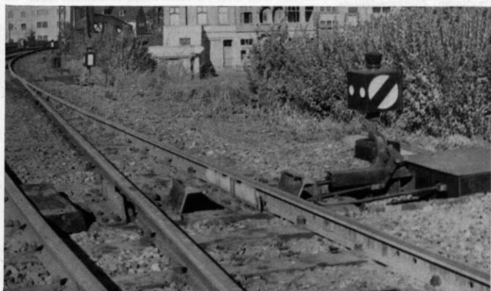
Abb. 3. Eine doppelte DB-Gleissperre in geöffneten Stellung. Vorn rechts das Gleissperren-Signal, weiter hinten (links) die Weichenlaterne. Rechts neben der am linken Bildrand verlaufenden Schiene die Auflaufplatte für das Rad in Form eines Holzklotzes. Eine zweite Auflaufplatte ist hier natürlich auch für den anderen Weichenzweig erforderlich. (Foto: Lokbildarchiv Bellingrodt, Wuppertal)
