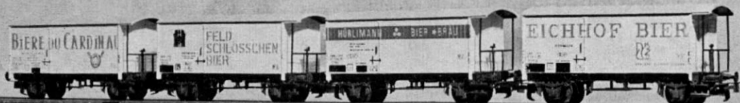
Abb. 147. Vier der insgesamt sechs Bierwagen, die auf der Basis des schweizerischen Güterwagens Typ K 2 entstanden.
