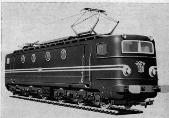
Abb. 159. Dieses H0-Modell der blauen, irgendwie elegant wirkenden niederländischen Co'Co'-Ellok (Serie 1300) hat eine LÜP von 21,7 cm. Die gleiche Maschine wird es auch in Hellgrün/Dunkelgrün mit SNCF-Beschriftung als „Mistral“-Lok geben (SNCF-Serie 7100).
