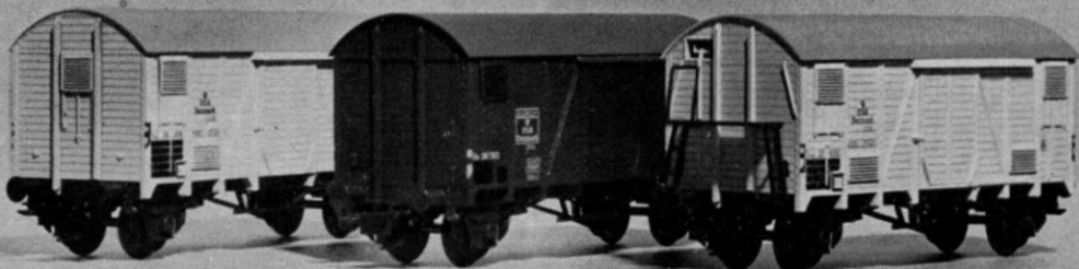
Abb. 148. Drei dänische Wagen auf dem „Oppeln“-Fahrwerk (v.l.n.r.): Kühlwagen mit Lüftungskappen an beiden Stirnseiten; DSB-EUROP-Güterwagen (mit erhöhtem Bremsenstand auf der hier nicht sichtbaren Stirnseite, ähnlich dem rechten Wagen); Kühlwagen mit erhöhtem Bremsenstand (letzterer einschließlich Geländer aus flexiblem und nahezu unzerbrechlichem Material).
