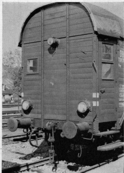
Abb. 2. Das Vorbild (für Abb. 1): einer der speziell für die Steilstrecke Boppard-Buchholz ausgerüsteten Zugbegleit- bzw. Bremswagen.
