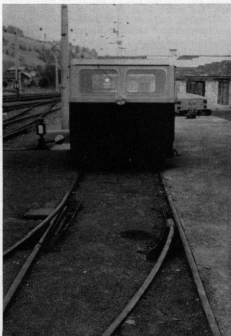
Abb. 4. Kleinkraftwagen im Kleinwagengleis. — Vorn die Einzungen-Weiche; das Weichenschloß befindet sich im Riffelblechkasten links neben der Zunge.
