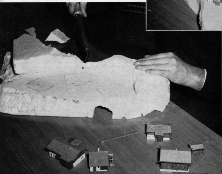
Abb. 4. Geländeformung mittels heißem LötKolben.
