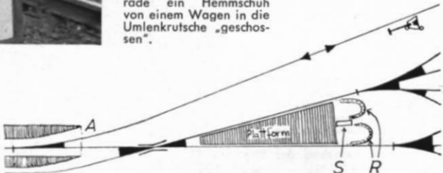
Abb. 2. Unmaßstäbliche Lageskizze der Hemmschuh-Auswerfer-Anlage, die Herr Langkau im Güterbahnhof-Berlin-Grunewald entdeckt hat. A = Ablaufberg, S = Hemmschuhständer, R = Rutschen für den Hemmschuh. Das obere Gleis führt zur Ausfahr- bzw. Einfahrgruppe.
