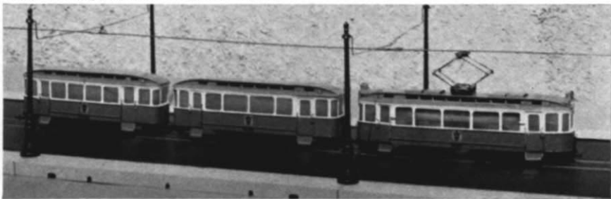
Abb. 5. Ein kompletter Zug der Münchner Straßenbahn: TW 635, BW 1425 und BW 1293. Bei den Drehgestellen des Triebwagens ist genau wie beim Vorbild jeweils die Achse mit den größeren Rädern angetrieben und in jedem Drehgestell befindet sich ein Motor!
