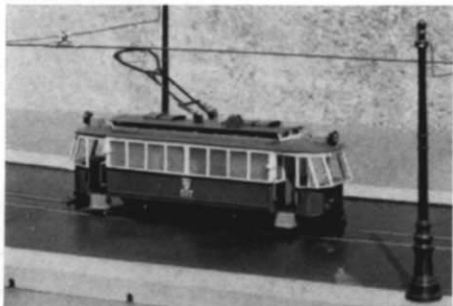
Abb. 2. Ein typischer Wiener Straßenbahntriebwagen mit der eigenartigen Kobelverglasung der Plattformform (schräggestellte Scheiben): TW 597 vom Typ G der WStW (Wiener Stadtwerke). Beide Achsen werden über ein Stirnradgetriebe angetrieben.
