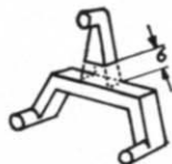
Abb. 1. Aus dem Reflexkörper ist ein 6 mm breites Stück herauszuschneiden.
