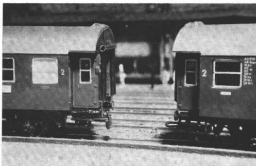
Abb. 10. Herr Chromek hat seine Trix-Wagen mit zurückgesetzten Märklin-Kupplungen ausgerüstet und die Kupplungsbügel nur einseitig an den Kupplungen belassen. Dadurch wird das verhältnismäßig weite Zurücksetzen überhaupt erst möglich.
