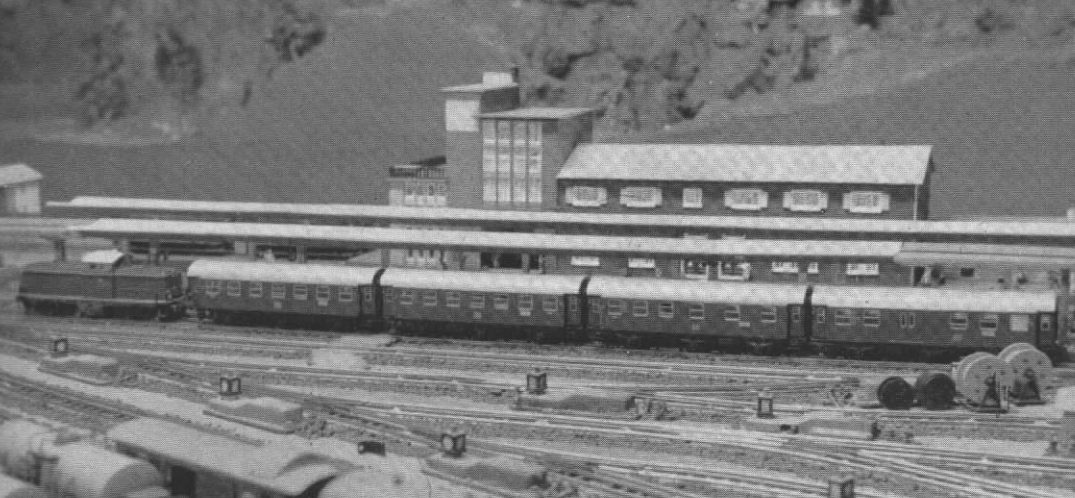
Abb. 5. Auch Herr Heinz Sammet aus Hersbruck hat mehrere kurzgekuppelte Züge auf seiner Trix-Anlage im Verkehr. Bei diesen Wagen hier ist die Kupplung leicht federnd und zieht sich bei der Fahrt etwas auseinander. Der stehende Zug bietet so ein nahezu völlig geschlossenes Bild, während bei der Fahrt die Wagen durch die Radreibung nur jeweils soweit wie erforderlich auseinandergezogen werden. Die Abstimmung der Federkraft ist allerdings etwas kritisch und hängt auch von der Wagenzahl ab. Da die Züge aber meist eine geschlossene Einheit bilden, genügt meist eine einmalige Justierung für jeden Zug.
