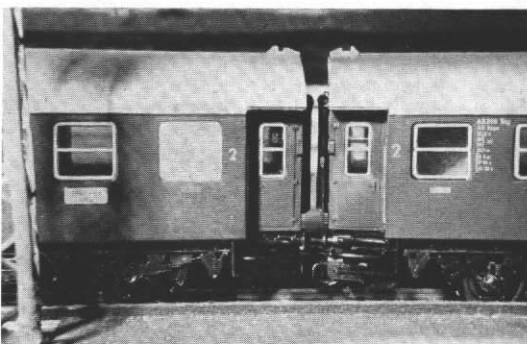
Abb. 11. Solch' enger Wagenabstand ergibt sich mit der Methode des Herrn Chromek.
