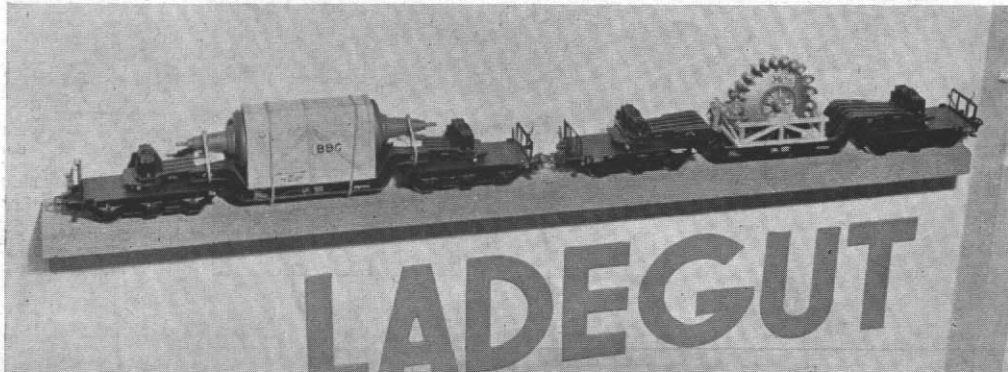
Abb. 77. Auf dem linken Tieflader der BBC-Turbinenläufer in Transportkiste, rechts das Voith-Turbinenrad.
