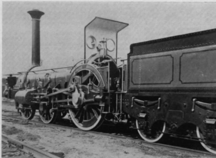
Abb. 1. Zwar nicht das Original unserer Bauzeichnung, aber dennoch eine typische Crampton-Lokomotive. Es ist „Die Pfalz“ der ehemaligen Pfälzischen Eisenbahn, gebaut 1853 von Maffei. Hier beginnt schon die Entwicklung des Führerhauses: Vorerst ist es jedoch noch nicht mehr als ein Windschutzschirm, um den Fahrtwind abzuhalten. (Foto: Bundesbahndirektion Nürnberg/Burger)
