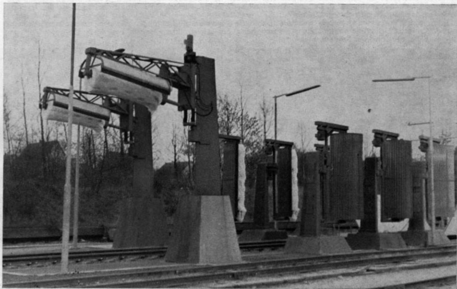
Abb. 8. Die Dachwalzen in Ruhestellung. Zur Reinigung des Daches werden sie über das Gleis geschwenkt. Da die Walzen über die Wagenmitte hinausreichen, sich aber gegenseitig nicht behindern dürfen, sind die beiden Pivot-Säulen in Längsrichtung des Gleises versetzt aufgestellt. Im Hintergrund die Seitenwandwalzen!
