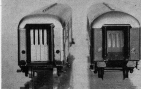
Abb. 13. Von vorn gesehen, fällt der Unterschied zwischen plastisch ausgeführten Puffern (Trix-Wagen rechts) und den geprägten bei dem Märklin-Wagen 4043 kaum auf. (Wenn die Puffer des Trix-Wagens farblich deutlicher hervortreten, so sind wir daran schuld, weil wir die arg schwarz glänzenden Kunststoff-Puffer dummerweise vor der Aufnahme etwas abgeschmirgelt hatten).
